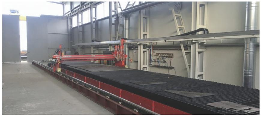
Portale di taglio dotato sia di taglio plasma che ossitaglio con capacità di taglio da 10 a 550 mm
