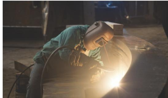
Operazione di scricatura su una saldatura in piena penetrazione
