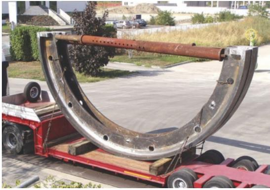
Porzione di ruota in due metà per il settore cementiero
