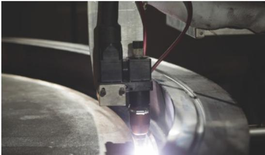
Dettaglio della saldatrice al plasma con cui si realizzano saldature su acciai dissimili
