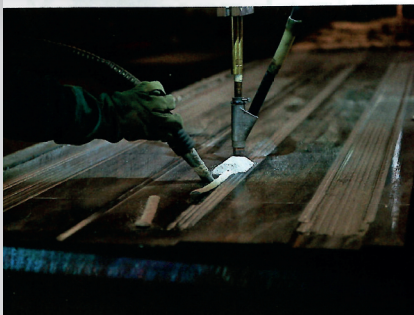
Beim Plasmaschweißen werden verschiedene Stahlsorten ohne „Nachschweißen“ gefügt. Großer Vorteil des Keyhole-Prinzips: Die Blech werden nur von einer Seite verschweißt.
