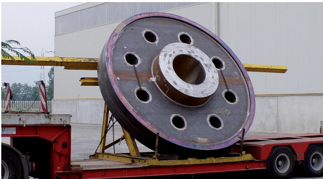
4 m di diametro e 19 ton di peso». Dimensioni imponenti, con spessori da 15 a 400 mm, allineati a un range di componenti normalmente processati da Imi come per esempio ingranaggi da 1,5 a 12 m di diametro, per pesi che sfiorano le 100 ton, oppure casse riduttori ed elementi di carpenteria di svariati metri.
